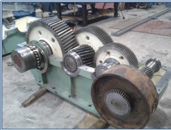
Reparación de reductor de traslación
