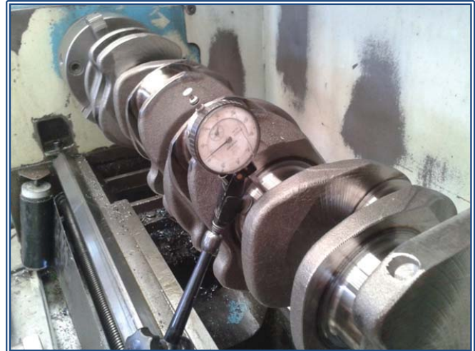
Toma de tolerancias en cigüeñal
